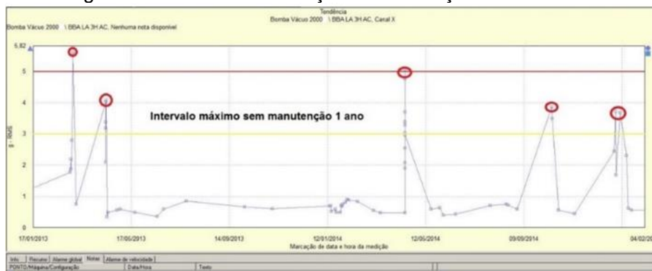
Figura 3 - Histórico de vibração e substituição do rolamento
