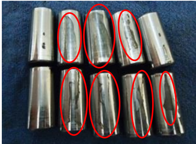
Figura 4 - Imagem dos elementos girantes com marcas de corrosão
