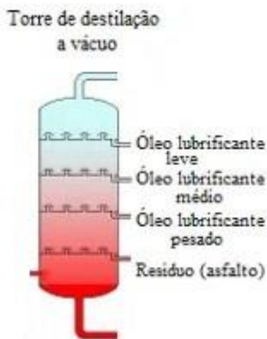
Figura 2 - Torre de destilação
