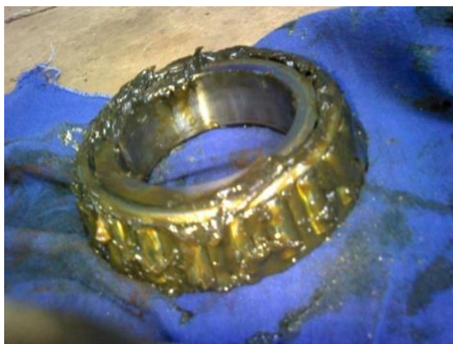
Figura 5 - Imagem do rolamento com o lubrificante contaminado.
