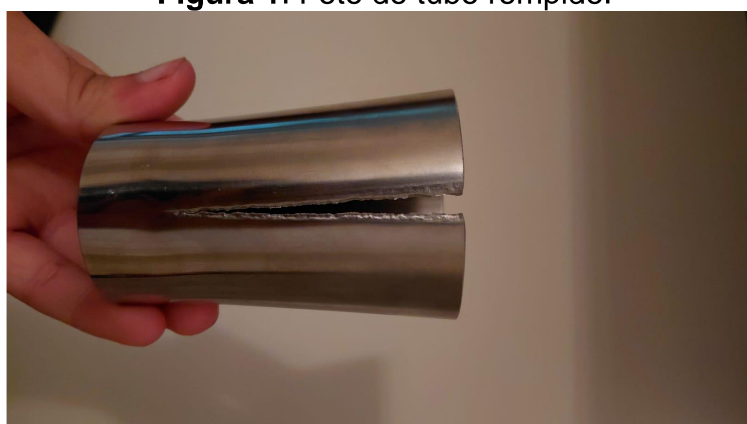
Figura 1. Foto do tubo rompido.
