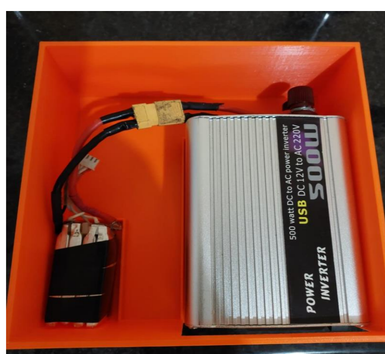
Figura 1. Protótipo com as baterias e o conversor de energia
