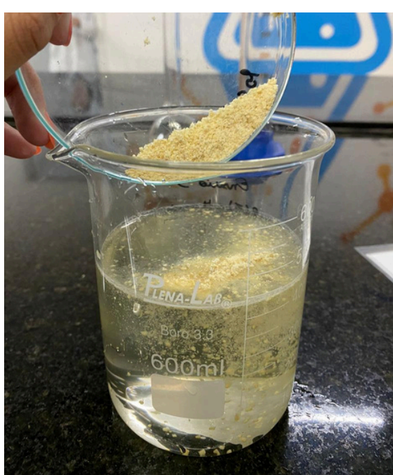
Figura 2. Água bruta com coagulante
