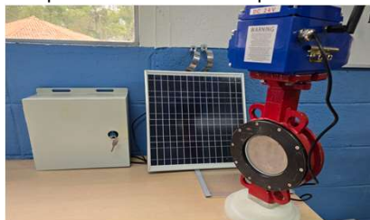
Figura 1. Válvula tipo Borboleta acionada por atuador a placa solar
