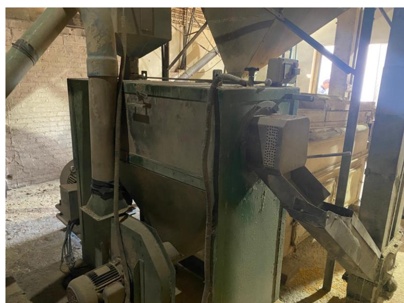
Figura 1. Degerminador horizontal utilizado.
