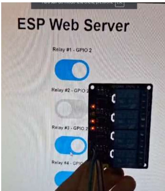
Figura 2. Site interagindo com o relé
