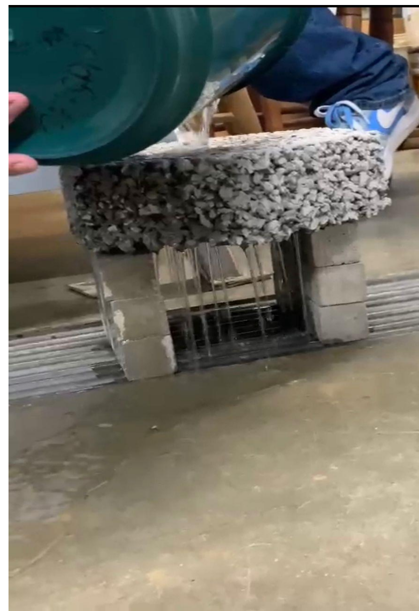
Figura 2. Concreto permeável em funcionamento
