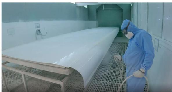
Figura 1. Processo de pintura Fiberbus
