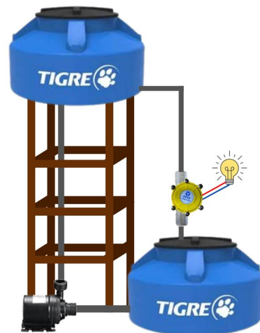
Figura 2. Representação da parte hidráulica do projeto.
