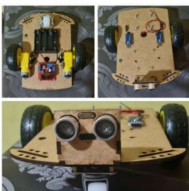
Figura 1. Robô autônomo
