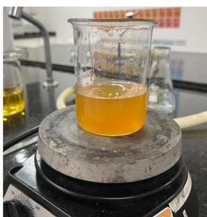
Figura 1. Processo de transesterificação do óleo residual
