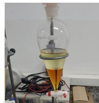
Figura 2. Processo de decantação do biodiesel.
