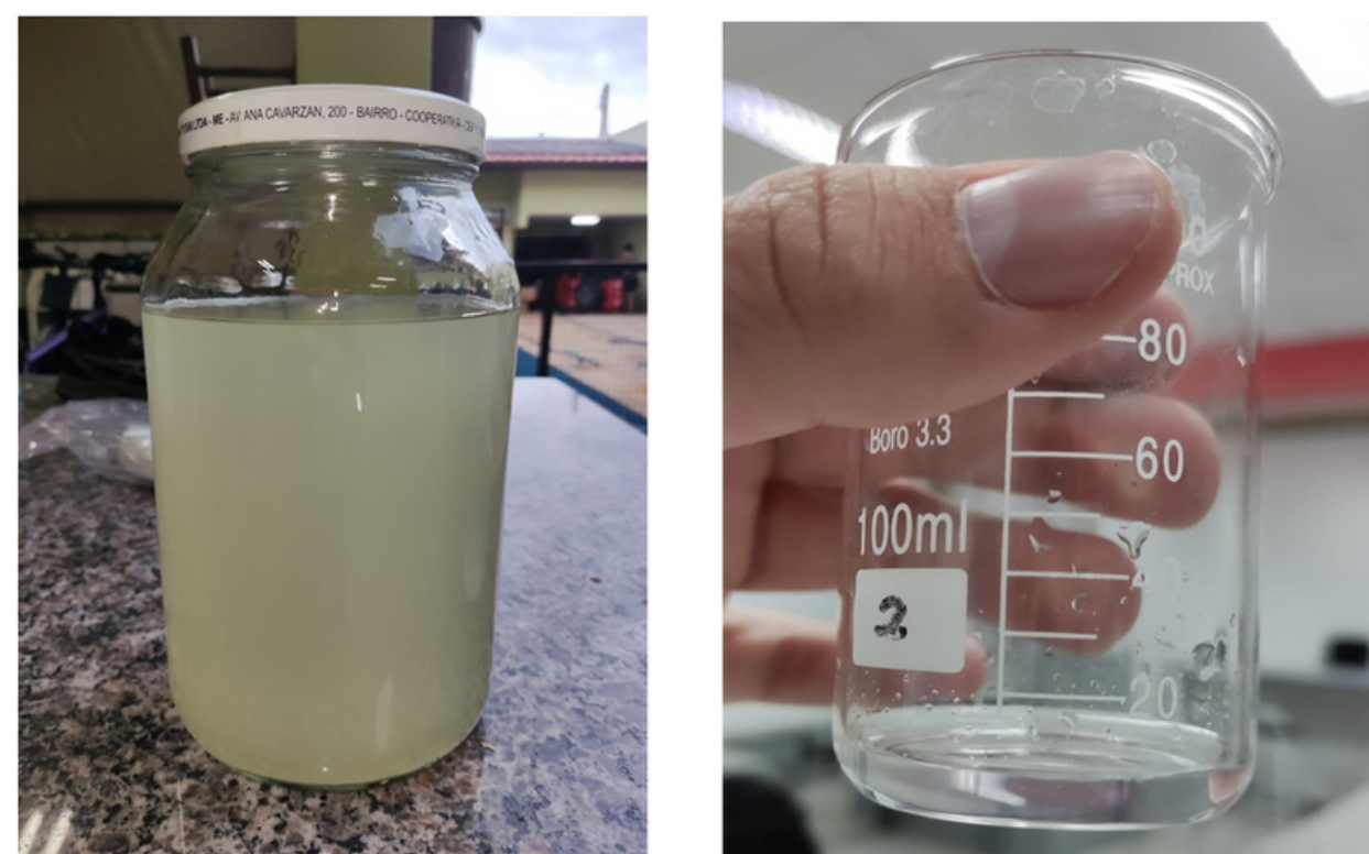
Figura 2-3. Antes e depois da destilação
