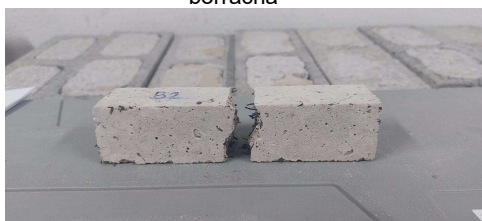
Figura 1. Concreto com adição de fibra de borracha
