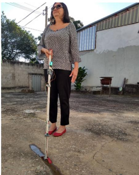
**Figura 10: Teste de detecção de obstáculos**
